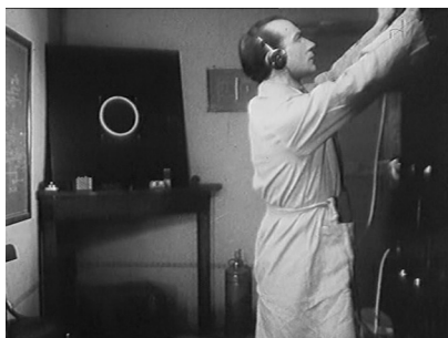
Fig. 24: L'interno della cabina del suono. L'operatore Giuseppe Caracciolo regola i volumi dei microfoni regolando il suono in entrata con le cuffie
